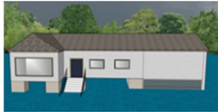
Elevar la estructura en su lugar
