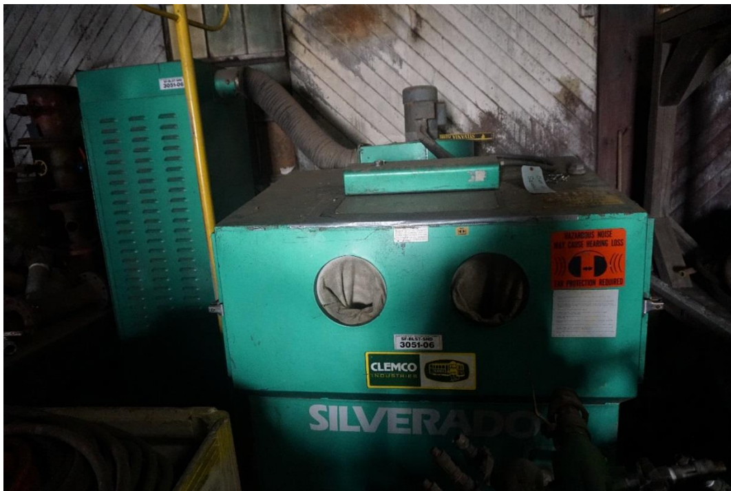
Silverado Sand Blast Cabinet (Bldg. 251)
